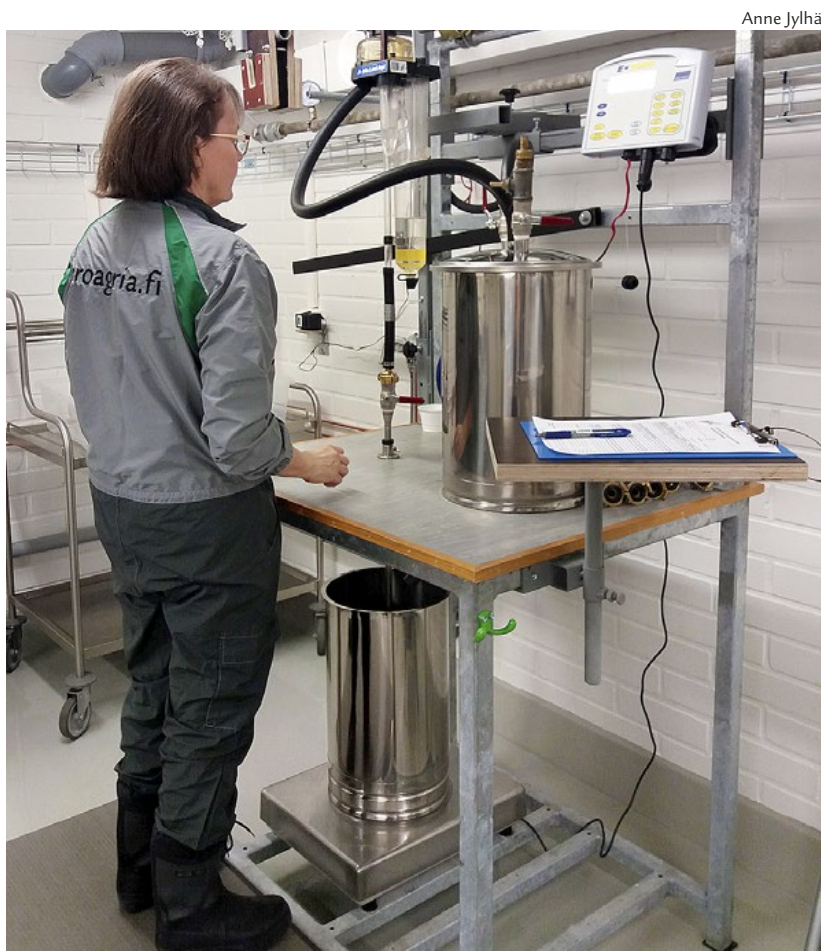
Salme Asiala testaamassa pestyjä, huollettuja ja säädettyjä maitomittareita.
